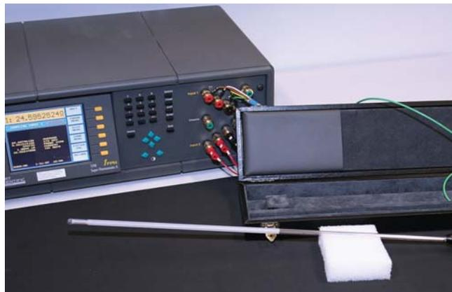
Thermomètre de référence SPRT (Standard Platinum Resistance Thermometer) étalonné selon IST90
