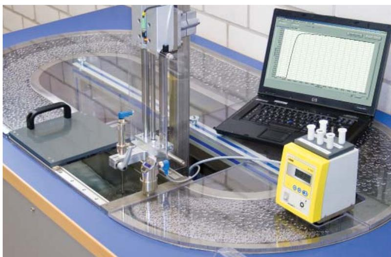
Détermination du temps de réponse d'un capteur TMR31 sur le banc de test d'eau en circulation
