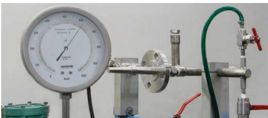
Test de contrainte dans un four à 900°C et test de pression hydrostatique
