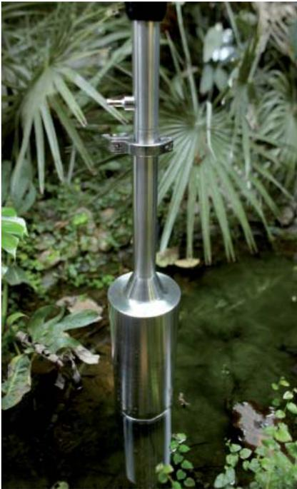
STIP-scan CAS74 est une sonde spectroscopique qui détermine le spectre d'absorption de l'échantillon des UV aux IR (voir aussi la mesure de nitrates en page 9). Un algorithme spécial calcule la concentration en équivalents DCO ou COT à partir de l'absorption dans cette gamme de longueur d'onde.
