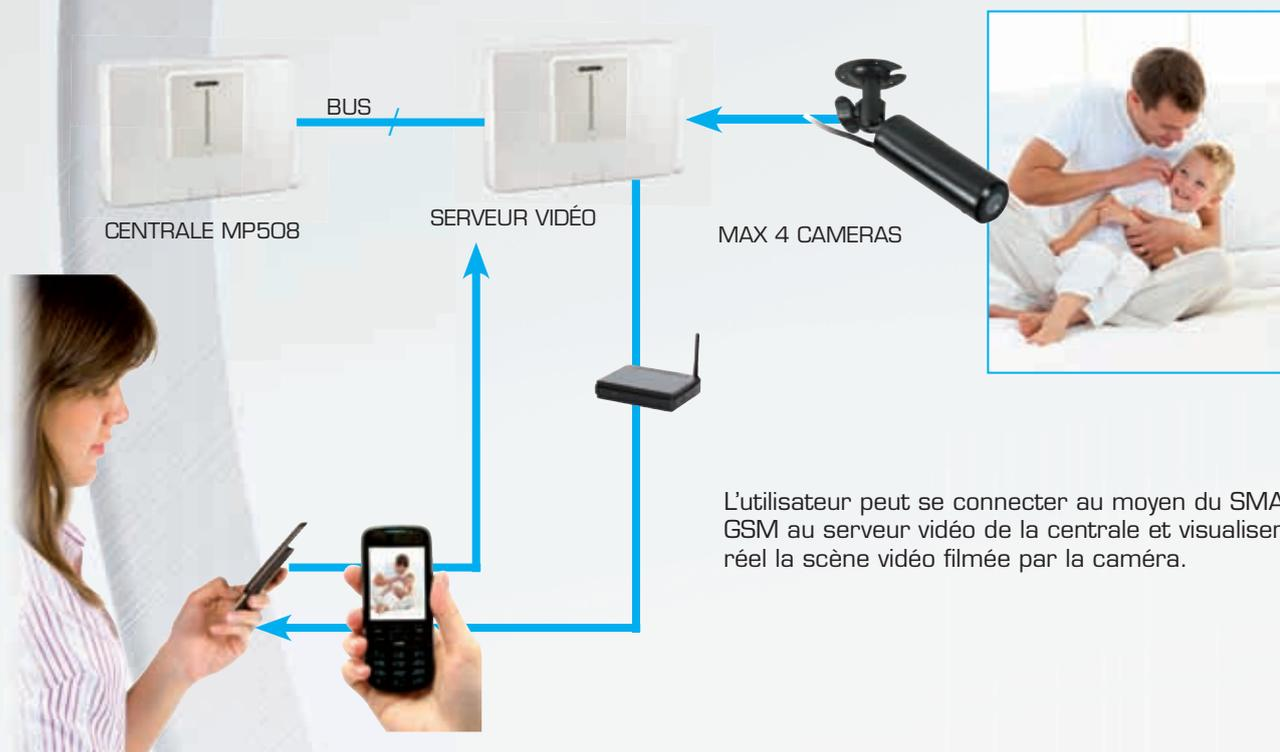
L'utilisateur peut se connecter au moyen du SMARTPHONE/GSM au serveur vidéo de la centrale et visualiser en temps réel la scène vidéo filmée par la caméra.
