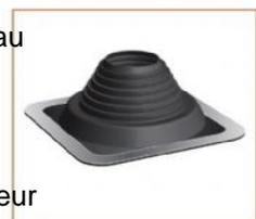
Dans le caoutchouc, on découpe une ouverture légèrement inférieure au diamètre extérieur du tuyau. Le raccord sera alors glissé sur le tuyau et rendu étanche au moyen de silicone.
